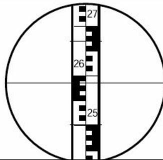
8. Определите расстояние от прибора до рейки
